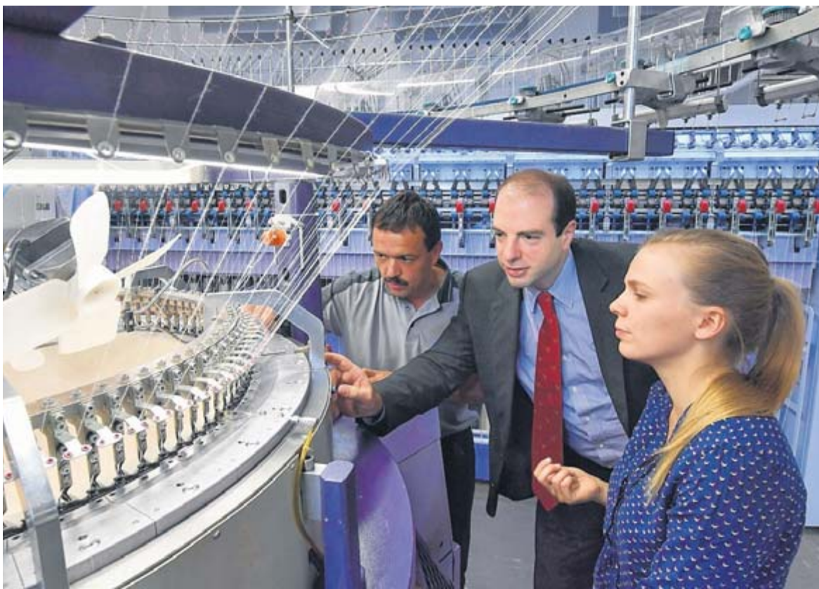
Bei der neuen Technologie des Textilmaschinenbauers Terrot wird das Garn direkt von den Spinnmaschinen in die Rundstrickmaschine geführt und nicht erst auf Spulen gewickelt. Im Bild: Geschäftsführer Andreas von Bismarck (Mitte), Miriam Härtel aus dem Bereich Forschung und Versuchsmitarbeiter Stephan Geiler. FOTO: WOLFGANG SCHMIDT
