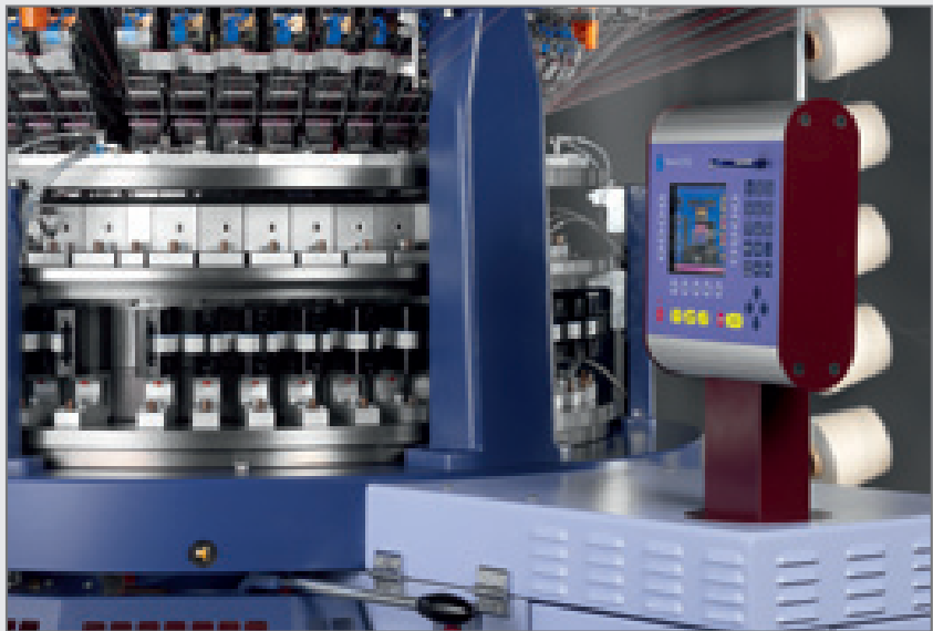
SCC6F548 – Strickkopf mit Bedieneinheit (Multiterminal)
